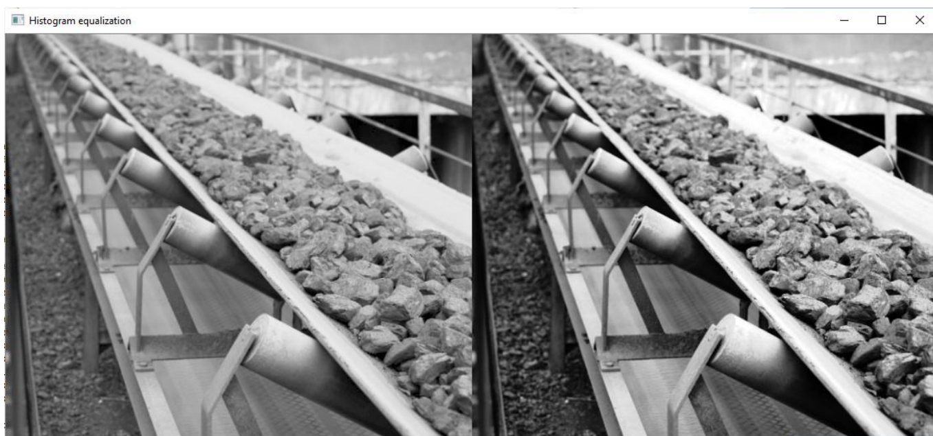
Рисунок 2.3 – Приклад застосування вирівнювання гістограми
