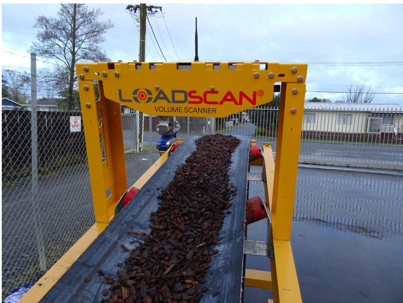
Рисунок 1.2 – Встановлений сканер об'єму вантажу конвеєрної стрічки
