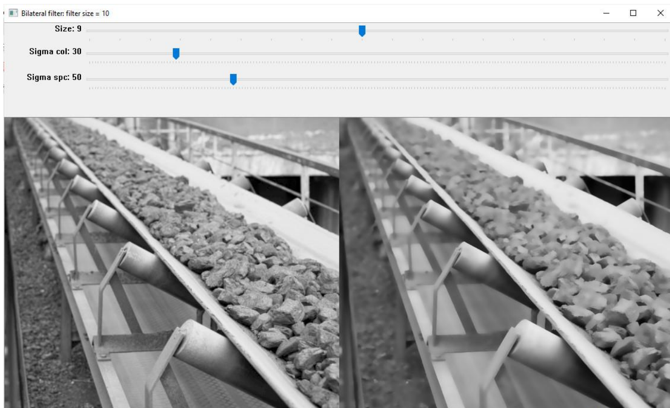
Рисунок 2.10 – Приклад застосування двосторонньої фільтрації
