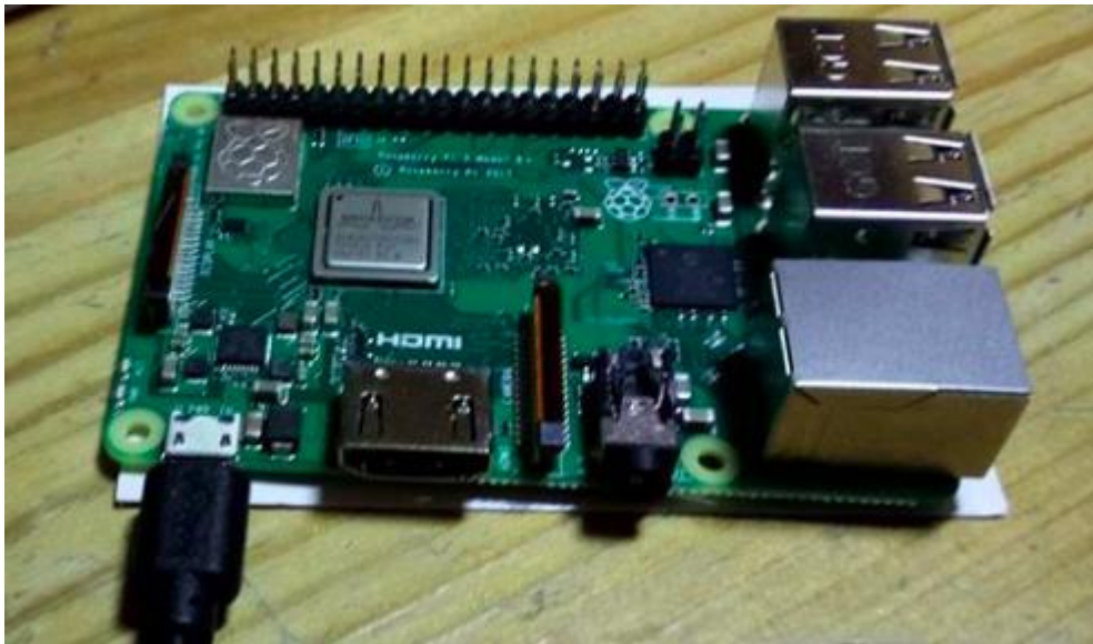
Рисунок 6.5 – підключення живлення Raspberry Pi по порту microUSB
