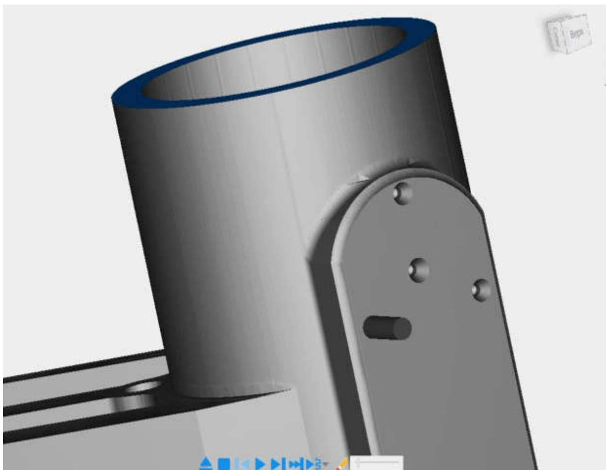
Рисунок 2 – Обробка одного з отворів свердлом діаметром 8,2мм
