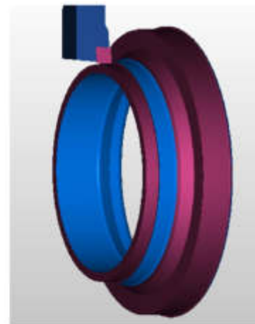
Рис. 3. Обработка внутренних цилиндрических и конических поверхностей
