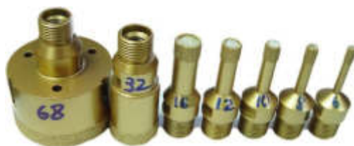
Рис 4.3 - Алмазні коронки вакуумного спікання, призначені для закріплення через перехідники.
