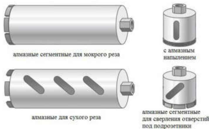
Рис 4.4 - Типи алмазних коронок
