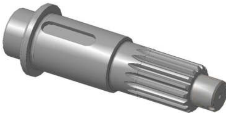
Рисунок 1 – “Шліцьовий вал” 3D модель
