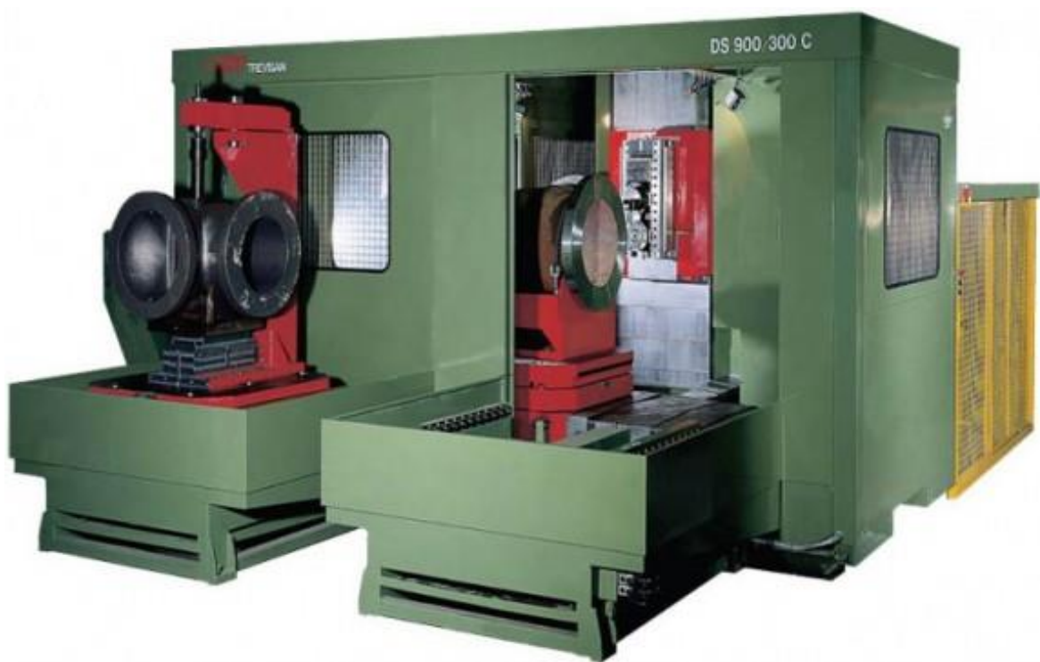
Рис 2.3 – Горизонтальний, двошпиндельний оброблювальний центр Trevisan модель DS 900/300C
