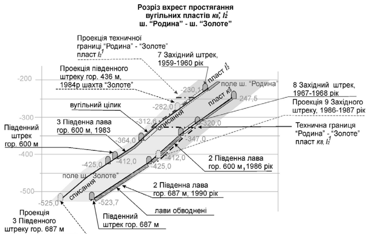
Рис. 2. Розріз вхрест простягання по сукупності вугільних пластів l_2^1 , k_8^6 з деталізацією розташування експлуатаційних виробок та років видобування вугілля.
