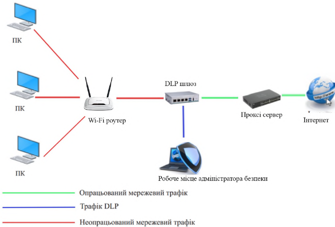
Рисунок 2.1 - Функціональна схема шлюзового рішення, в режимі блокування
