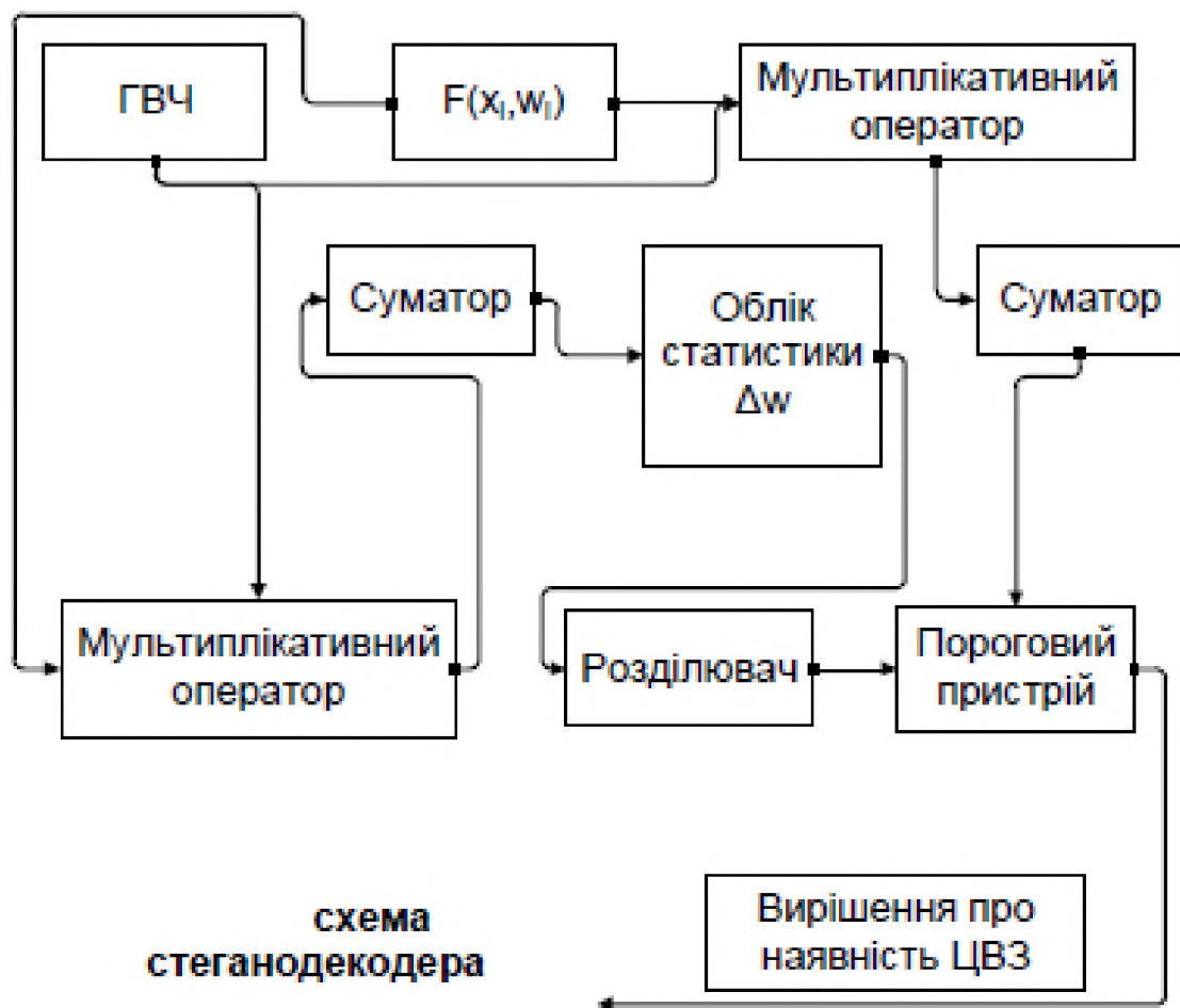
Рисунок 1.8 – Схеми стеганокодера і стеганодекодера згідно відомого підходу-прототипу [2, 32, 33]
