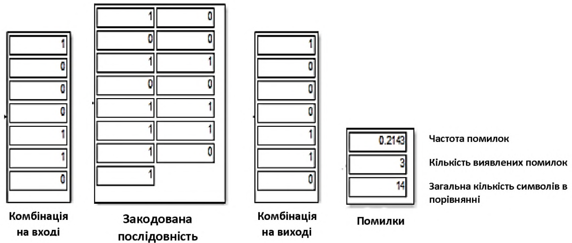
Рисунок 2.11 – Комбінація на вході, закодована послідовність, комбінація на виході, помилки (ймовірність помилок дорівнює 0,6)
