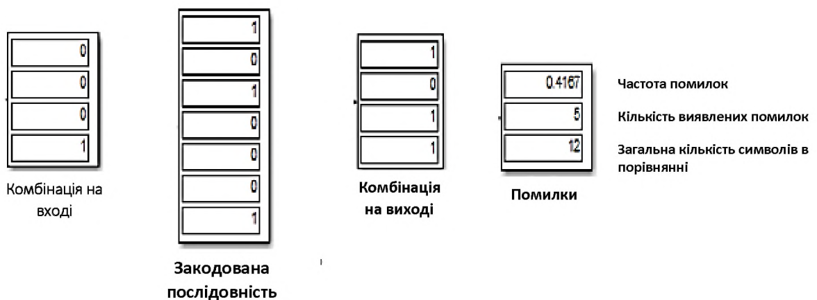
Рисунок 2.3 Комбінація на вході, закодована послідовність, комбінація на виході, помилки (ймовірність помилок дорівнює 0,4)
