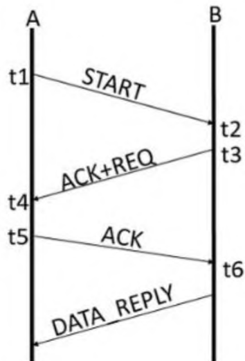
Рисунок 2.6 – Принцип работы метода SDSTWR
