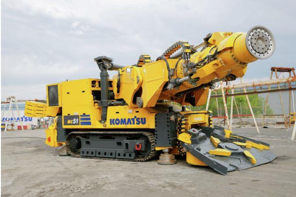
Рисунок 2 – Komatsu MC-51 машина для руйнування порід високої міцності
