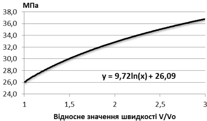
Рис. 4. Залежність міцності зразків гірських порід від швидкості навантаження (V – швидкість при поточному експерименті; V 0 – «початкова» швидкість)
