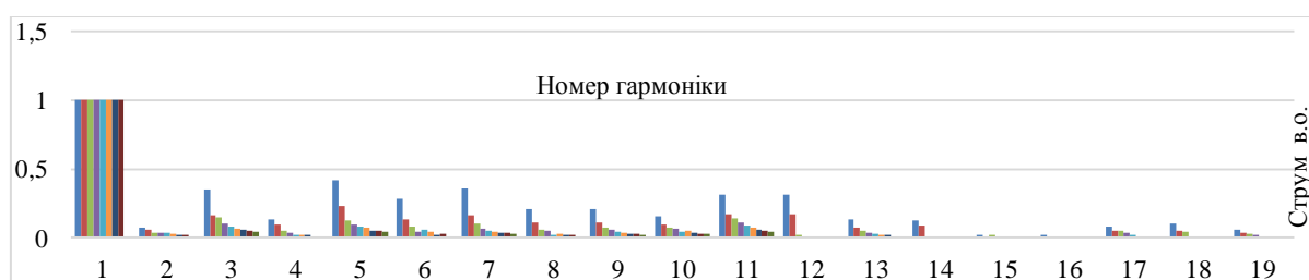
Рисунок 5 – Гармонійний склад режиму роботи мережевого інвертора у стаціонарних режимах за навантаженням
