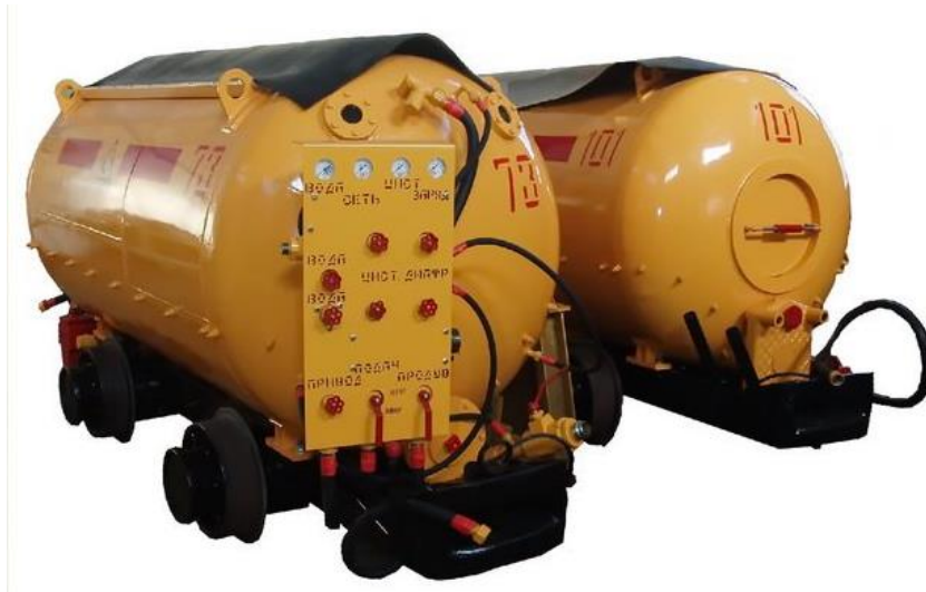
Рисунок 2.3 – Машина транспортно-зарядна модель МТЗ-3
