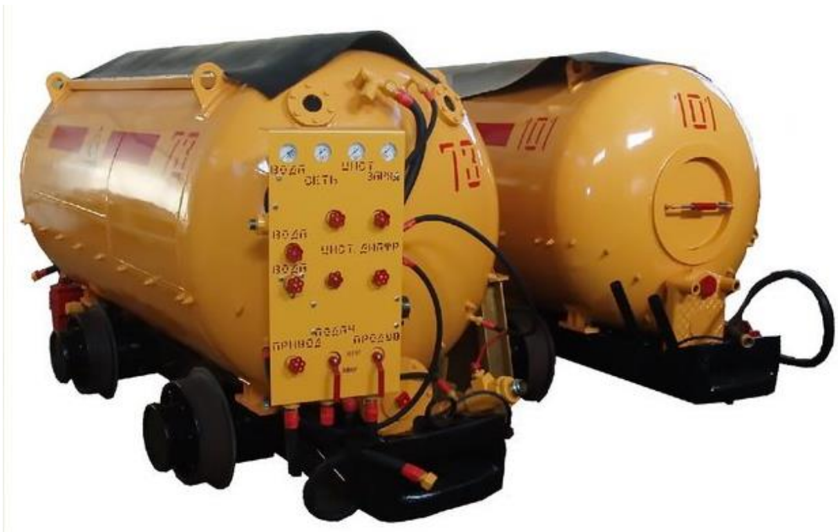
Рисунок 2.2 – Машина транспортно-зарядна модель МТЗ-3
