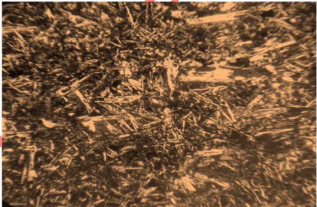
Рисунок 3.27 – Фібробластова структура з елементами епідотової в амфіболіті Нік+, зб.90
