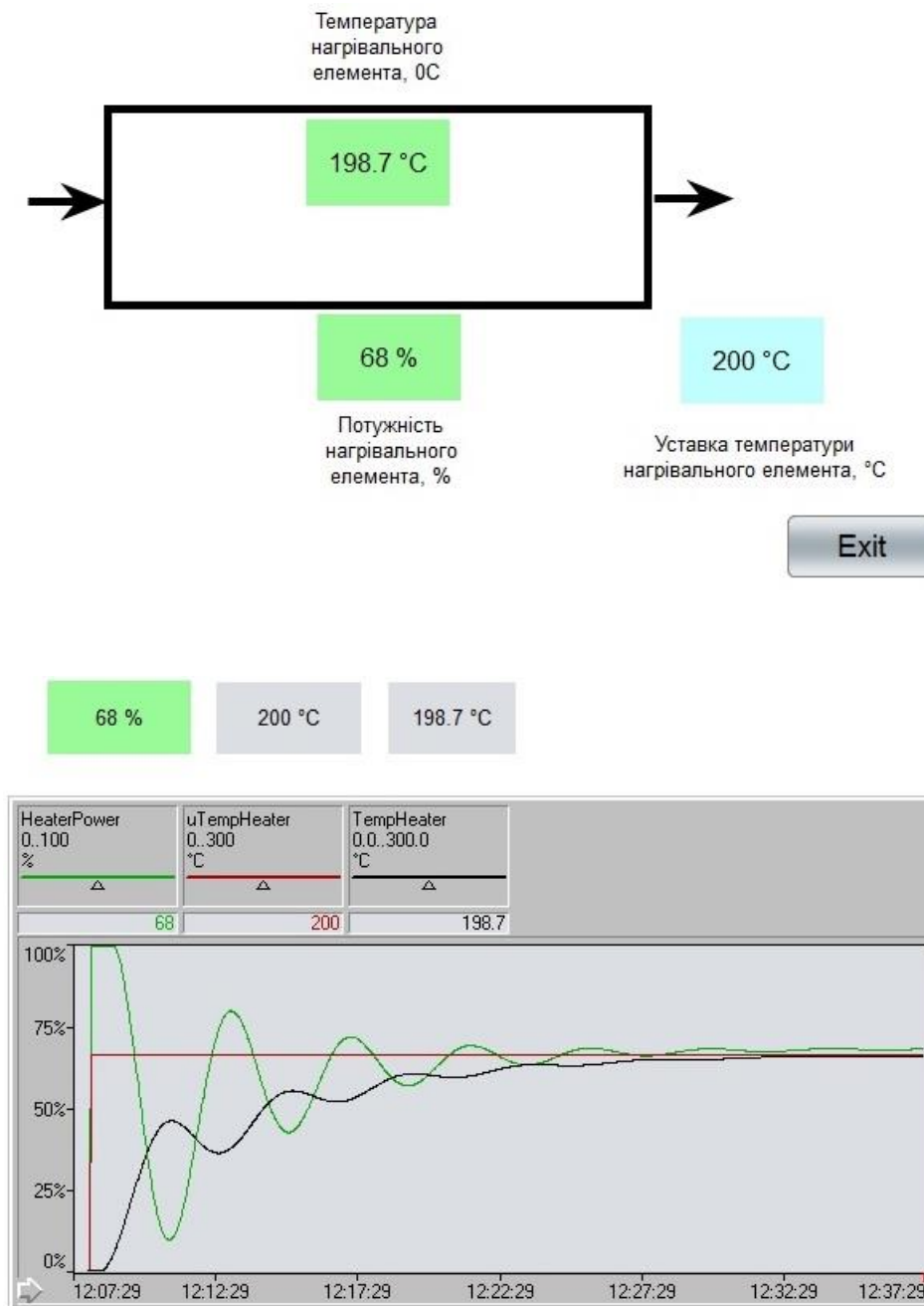
Рисунок 4.13 – Зображення моніторингу зміни температури нагрівального елемента екструдера
