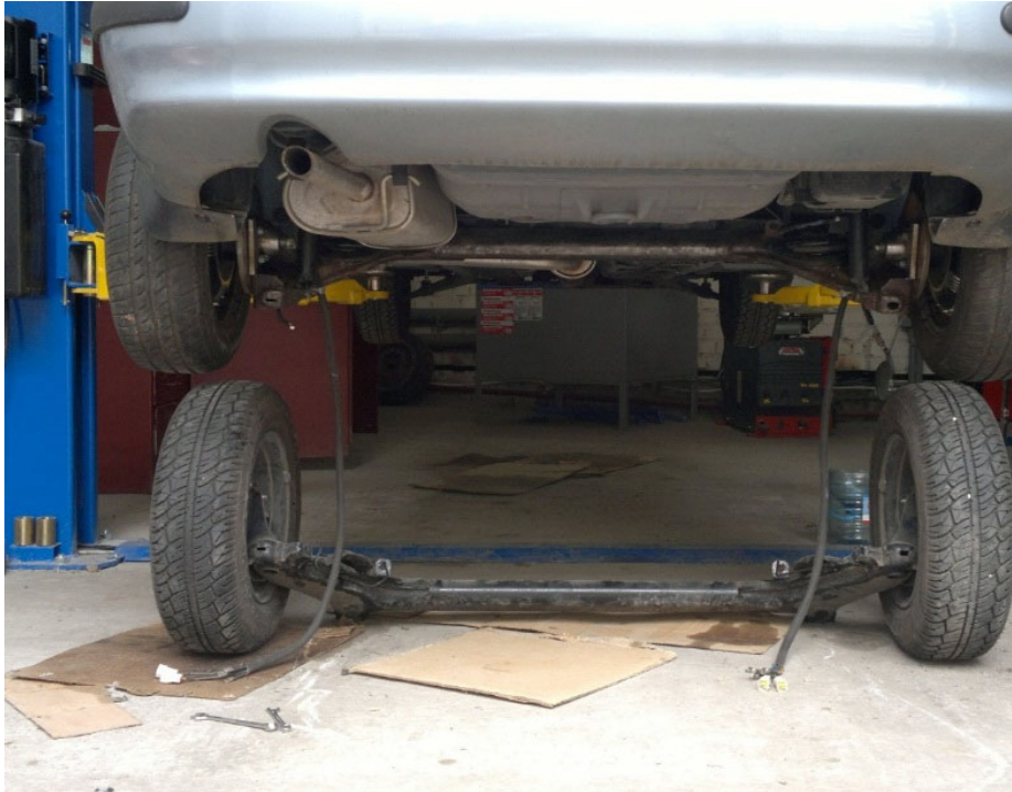
Рисунок 2 – Заміна задньої балки автомобіля ЗАЗ СЕНС
