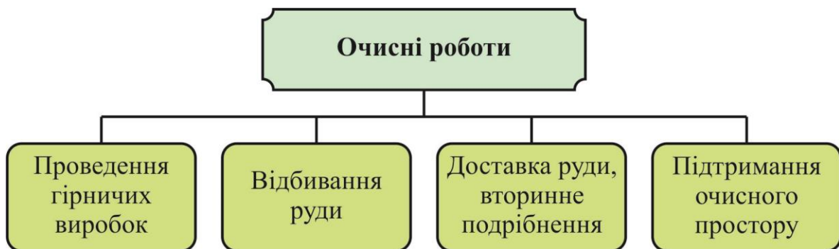
Рис. 3.1. Класифікація комплексу робочих процесів при виробничій стадії очисних робіт
