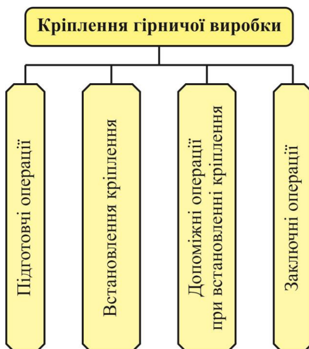
Рис. 2.19. Класифікація операцій у робочому процесі кріплення гірничої виробки
