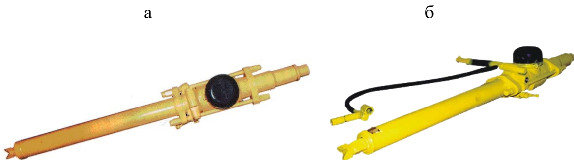
Рис. 2.5. Загальний вигляд телескопних перфораторів: а – ПТ-38 Б; б – ПТ-48 А
