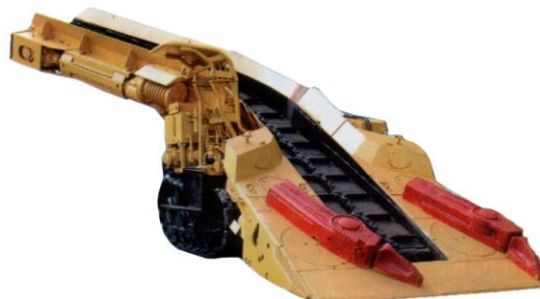
Рис. 2.16. Зовнішній вигляд навантажувальної машини безперервної дії типу ПНБ-3Д2
