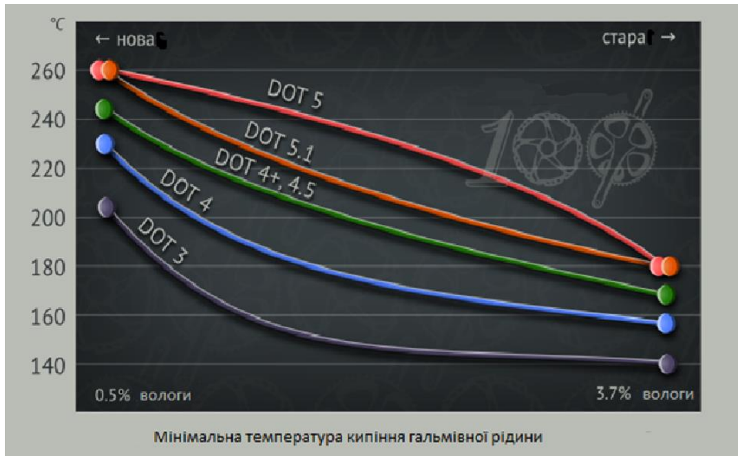
Рис.2 Температура кипіння класів гальмівної рідини, відповідно до стандарту
