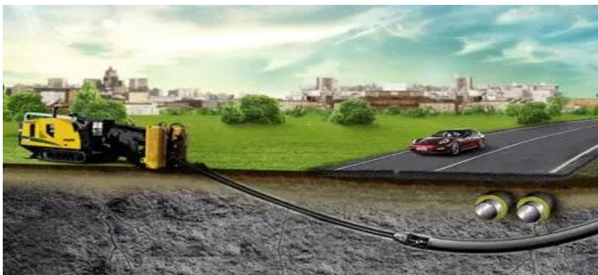
Рис. 4 – Метод горизонтального буріння
