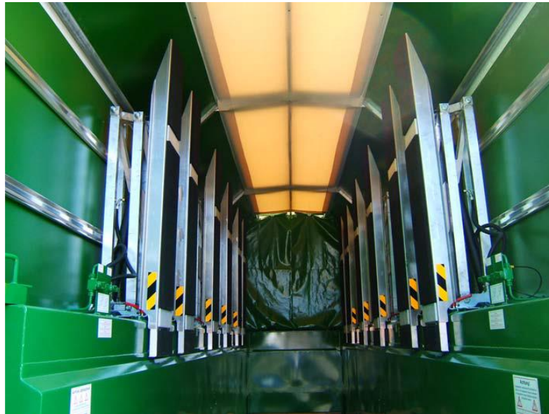
Рис. 2 Система фіксації вантажів у інлоудері
