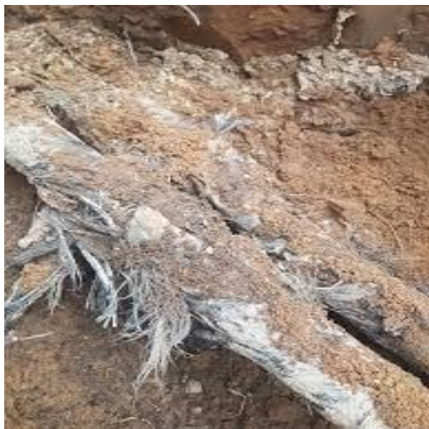
Рис.1 – Кабель з паперовою оболонкою, який використовується більше свого терміну використання.
