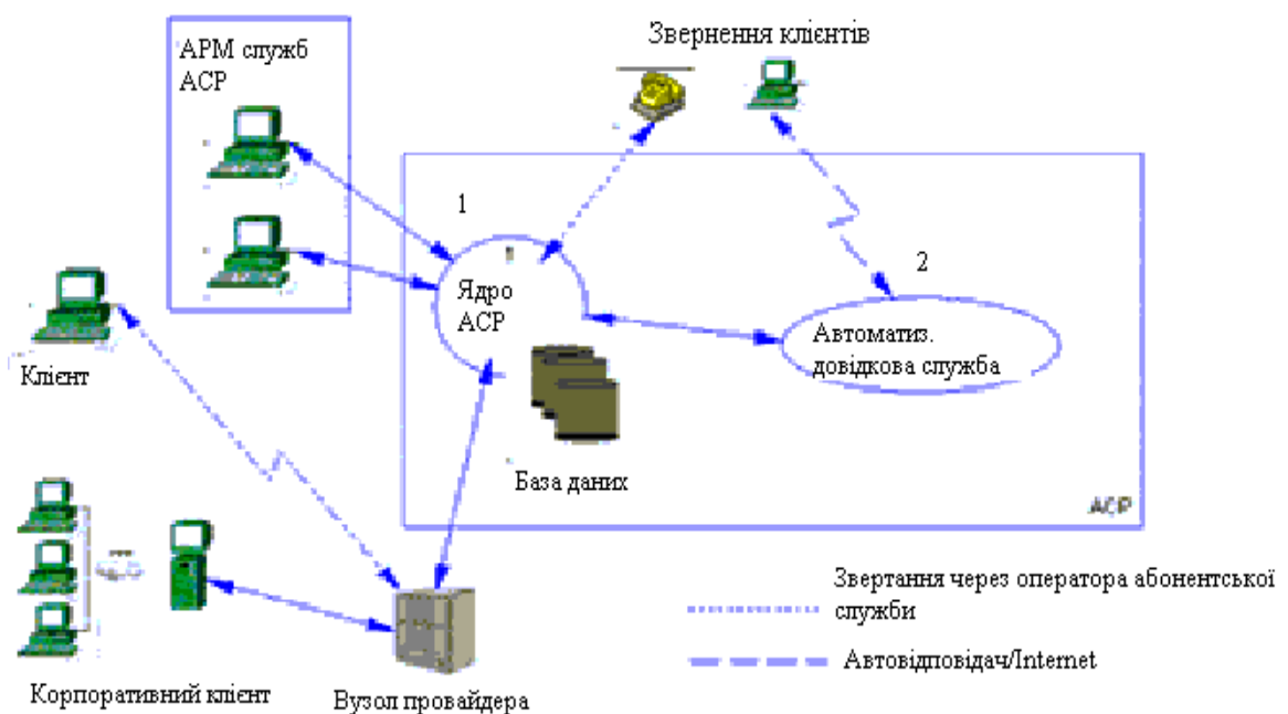
Рис. 6.1. Функціональна схема АСР
