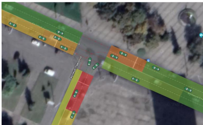
Рисунок 1 – Побудована у програмному середовищі AnyLogic модель дорожнього руху на Т-подібному перехресті
