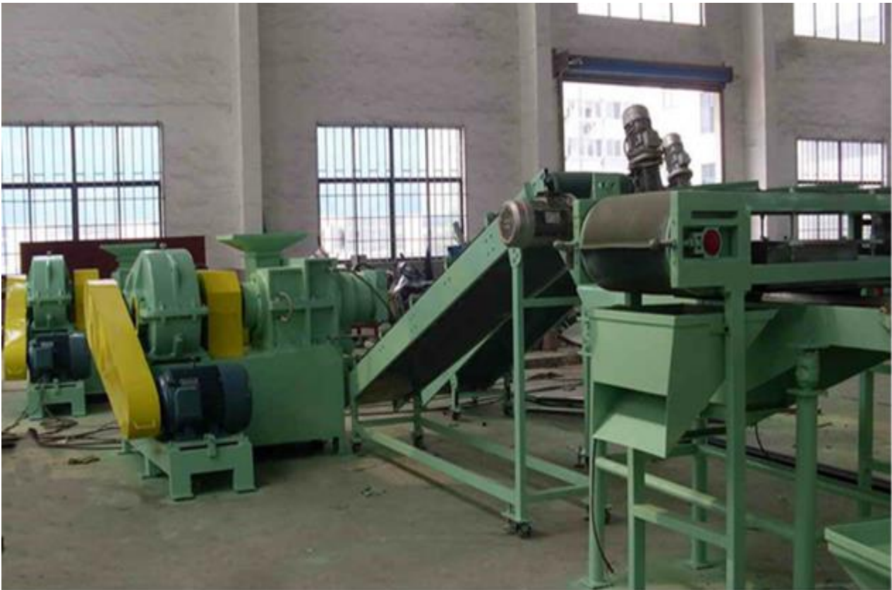
Рисунок 2.3 – Зовнішній вигляд лінії для переробки шин в крихту ЛПШК-2000
