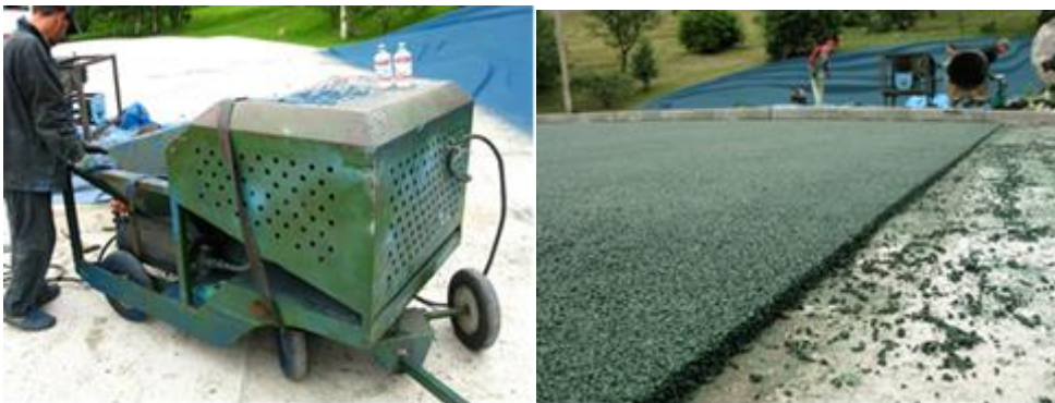
Рисунок 2.10 – Розпилювач гумової крихти РТJ-120 і нанесене ним безшовне покриття з гумової крихти
