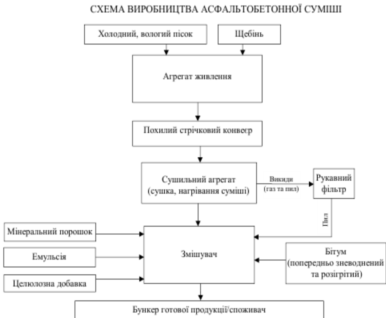
Рисунок 1.7 – Схема технологічного процесу виготовлення асфальтобетонної суміші
