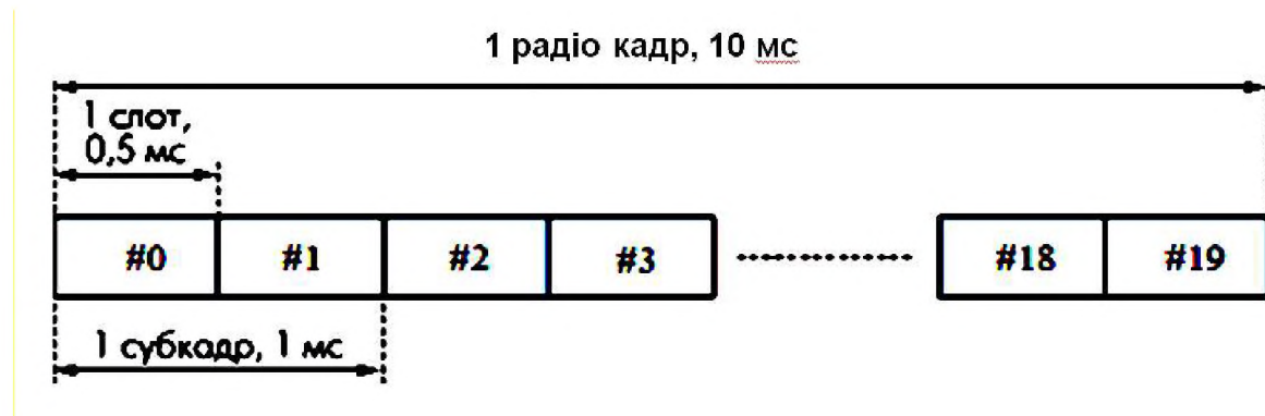
Рисунок 1.6 – Структура кадру LTE при частотному поділенні дуплексних каналів
