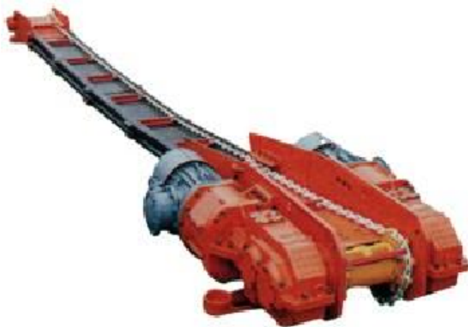
Рисунок 2.4 – Загальний вид скребкового конвєсєру CP70 [12]
