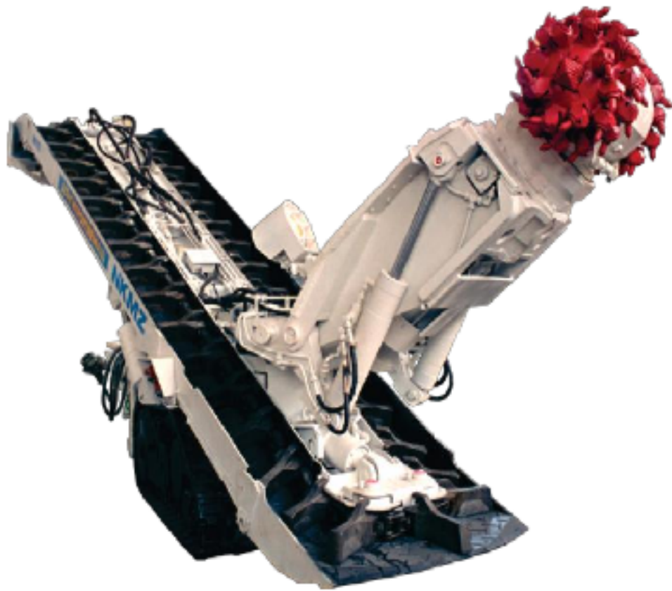
Рисунок 2.3 – Загальний вид машини поддирочно навантажувальної з різьбовим виконавчим органом
