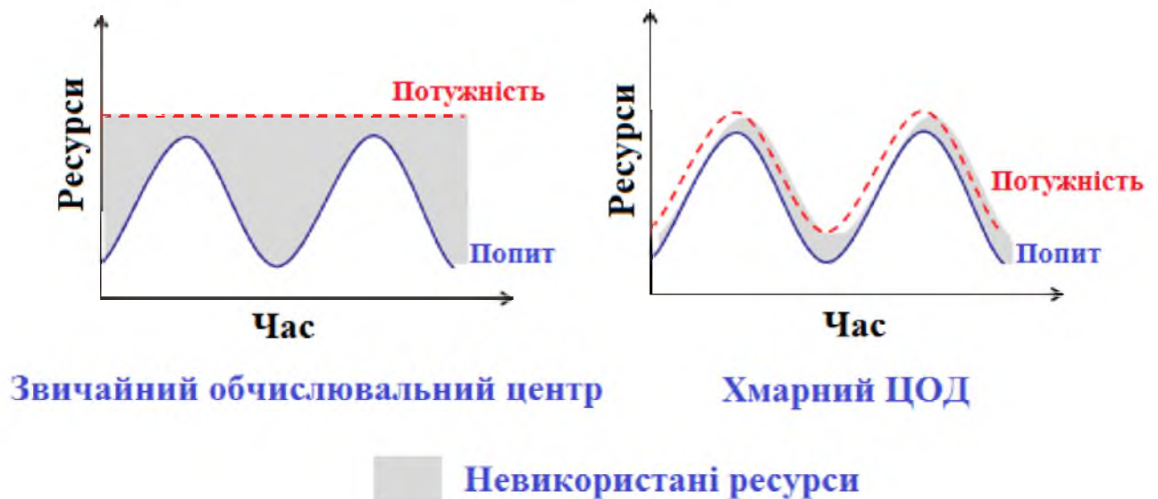
Рисунок 1.4 – Переваги «хмарного» ЦОД
