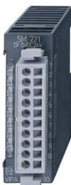
Рисунок 2.11 – Модуль дискретного виводу VIPA 222-1BF00
