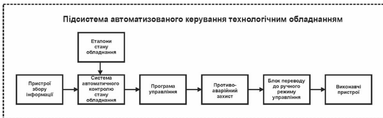
Рисунок 2.2 – Структурна схема інформаційних потоків
