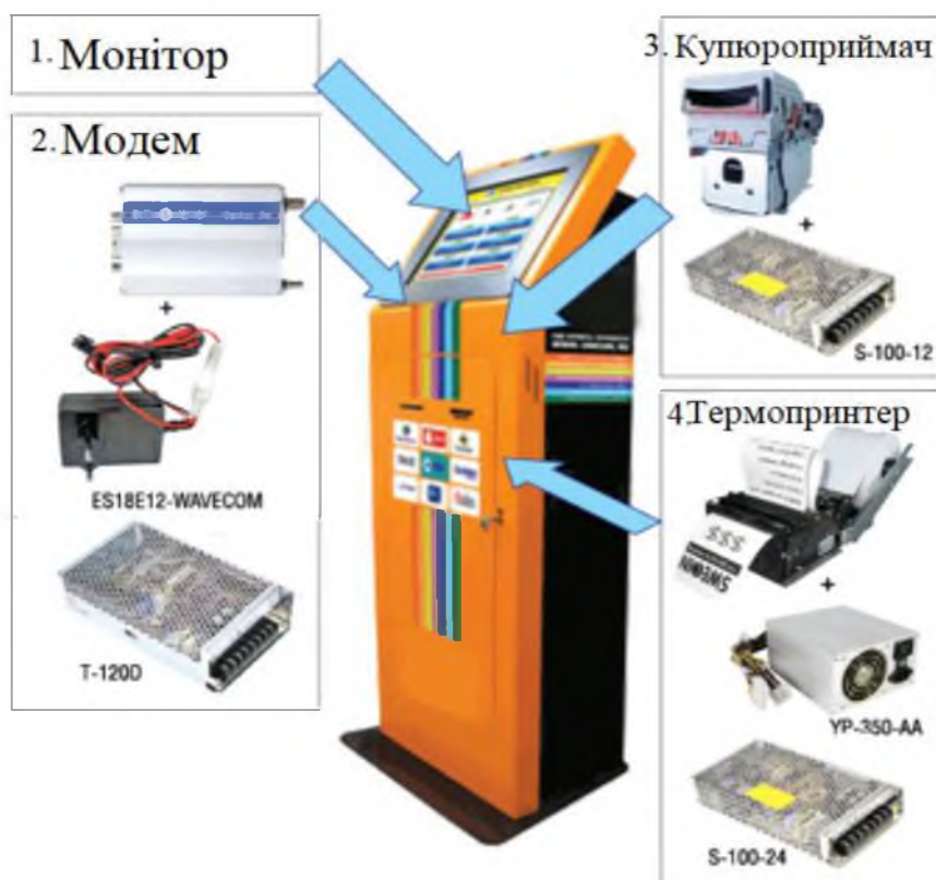
Рисунок 1.2. — Схема розміщення кожного з компонентів платіжного терміналу.
