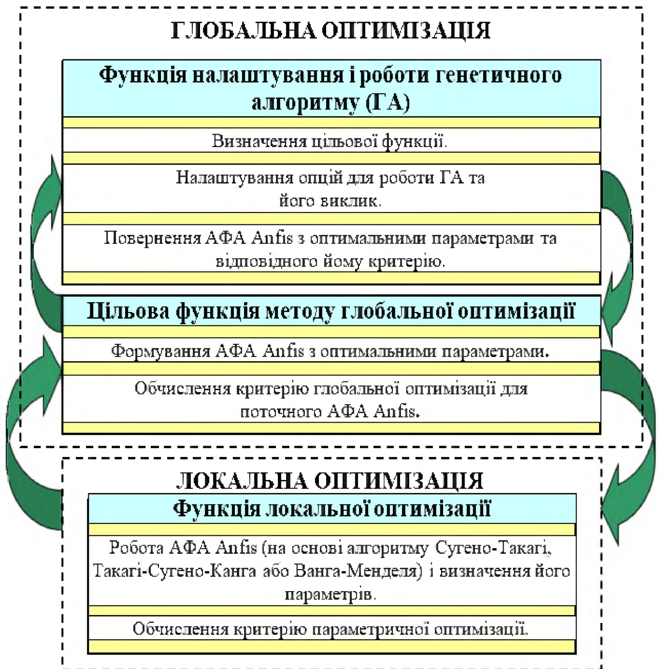
Рисунок 2.1 – Узагальнена структура алгоритму прогнозування мережевого трафіку згідно запропонованого підходу із використанням адаптивних мереж нечіткого висновку та генетичного алгоритму
