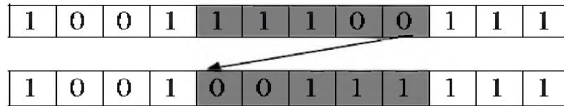
Рисунок 1.11 – Приклад виконання інверсії
