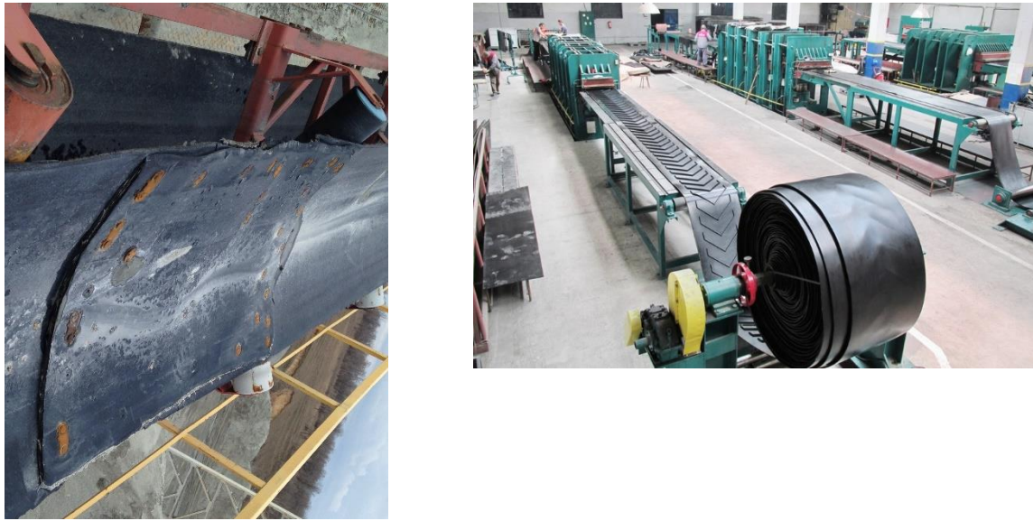
Рисунок 1 – Технології ремонту конвеєрних стрічок (а) та укладання їх в рулони (б) для транспортування в гірничих виробках
