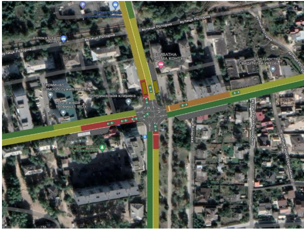
Рисунок 6 – Процес імітації дорожнього руху транспортних засобів на нерегульованому перехресті
