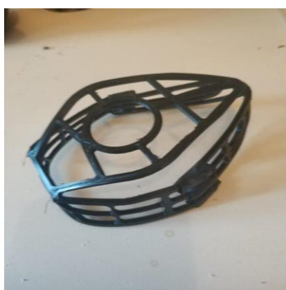
Рисунок 3.32 – Загальний вигляд ПФР з геометрією смуги обтюрації, що змінюється: а – каркас, б – макет ПФР.
