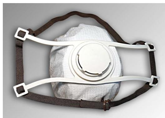
Рисунок 3.32 – Загальний вигляд ПФР з геометрією смуги обтюрації, що змінюється: а – каркас, б – макет ПФР.
