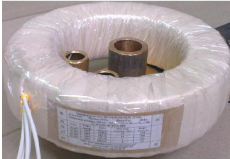
Рис 2.3. Трансформатор струму типу “ТВ-35-10У1”.
