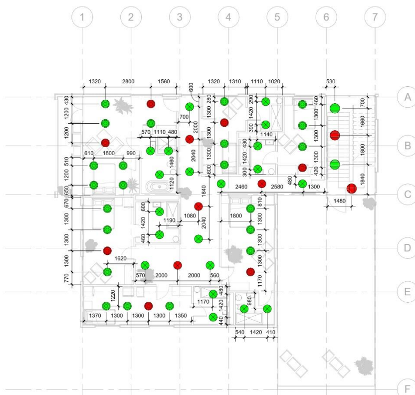
Рисунок 15 – Розташування світильників на 2 поверсі
