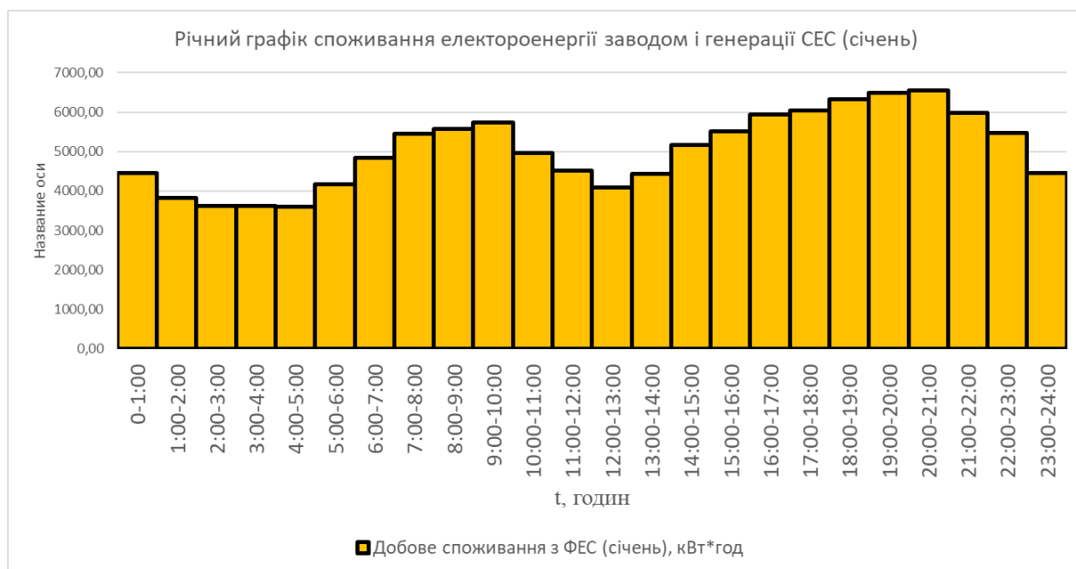
Рисунок 2.23 – Добовий графік споживання електроенергії заводом і генерації СЕС (січень)
