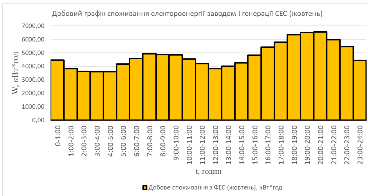
Рисунок 2.41 – Добовий графік споживання електроенергії заводом і генерації СЕС (жовтень)
