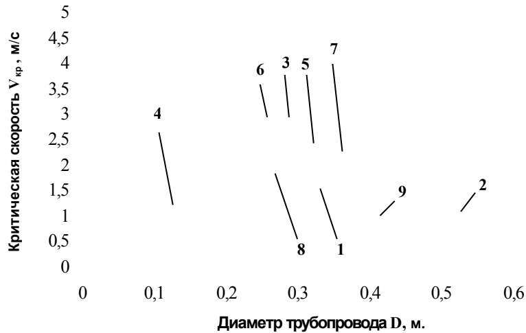
Рис. 1. Зависимости критической скорости транспортирования гидросмеси от диаметра нагнетательного трубопровода (при \rho_{\text{ТВ}} = 2700 \text{ кг/м}^3 ; S = 0,1353 ; S_1 = 0,0276 ; S_2 = 0,1070 ; S_3 = 0,0012 ; \delta = 0,2174 \cdot 10^{-3} \text{ м} ), рассчитанные по формулам А.Е. Смолдырева для тонких (1), мелких (2), кусковых (3), полидисперсных гидросмесей (4) классов, упрощенной формуле (5), а также В.С. Мучника (6), ДПИ (7), А.П. Юфина, с учетом однородности гранулометрического состава (8) и больших трубопроводов (9)
