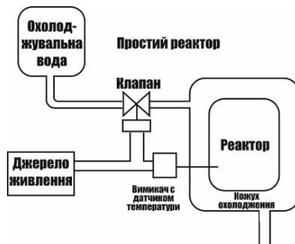
Рисунок 1 – Схема охолодження «спрошеного» реактора
