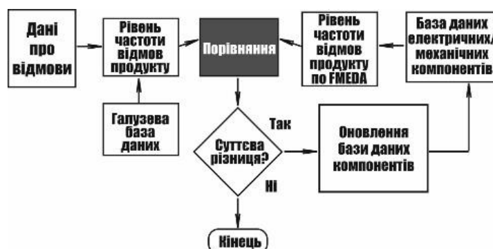
Рисунок 3 – Алгоритм дій методу «FMEDA»
