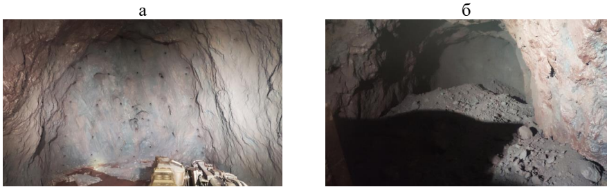
Рисунок 8 – Фотофіксація вибою орту горизонту 910 м до вибуху (а) та після вибуху (б) за розрахованими параметрами БПР в умовах ПрАТ «ЗЗРК»
