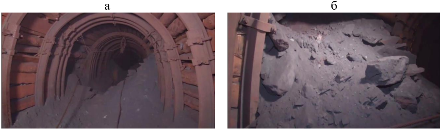
Рисунок 9 – Фотофіксація у штреку скреперування (а) та дучці (б) результатів подрібнення руди після її відбивання з використанням наливної ЕВР Україніт-ПП-2 при відпрацюванні запасів експериментального блоку
