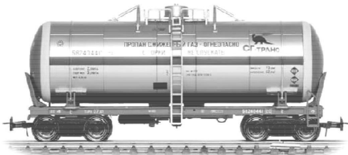
Рисунок 9.6 – Цистерна для перевезення скраплених газів
