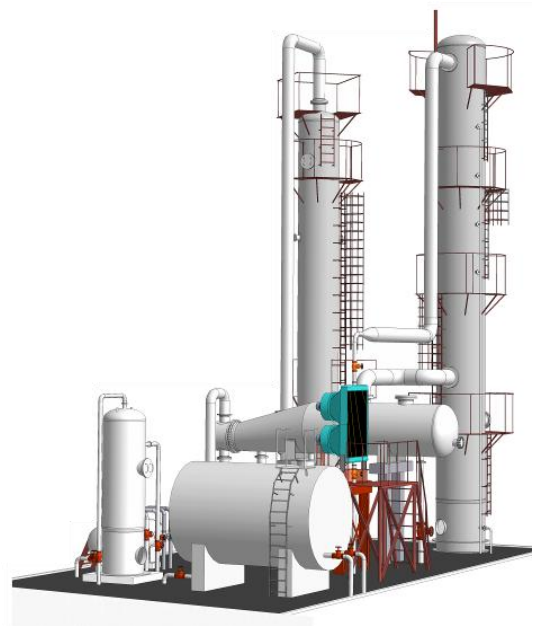
Рисунок 11.35 – Модель абсорбційної установки очищення газів від кислих домішок
