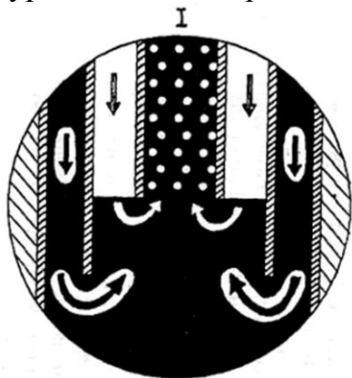
Рисунок 7.25 – Механізм компресорного видобутку нафти
