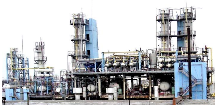
Рисунок 11.48 – Абсорбційно-газофракціонуюча установка (АГФУ) Гнідинцівського ГПЗ (ВАТ «Укрнафта»)
