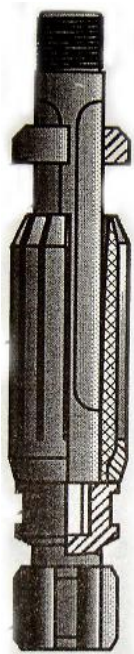
Рисунок 5.10 – Поршень (сваб) манжетного типу
