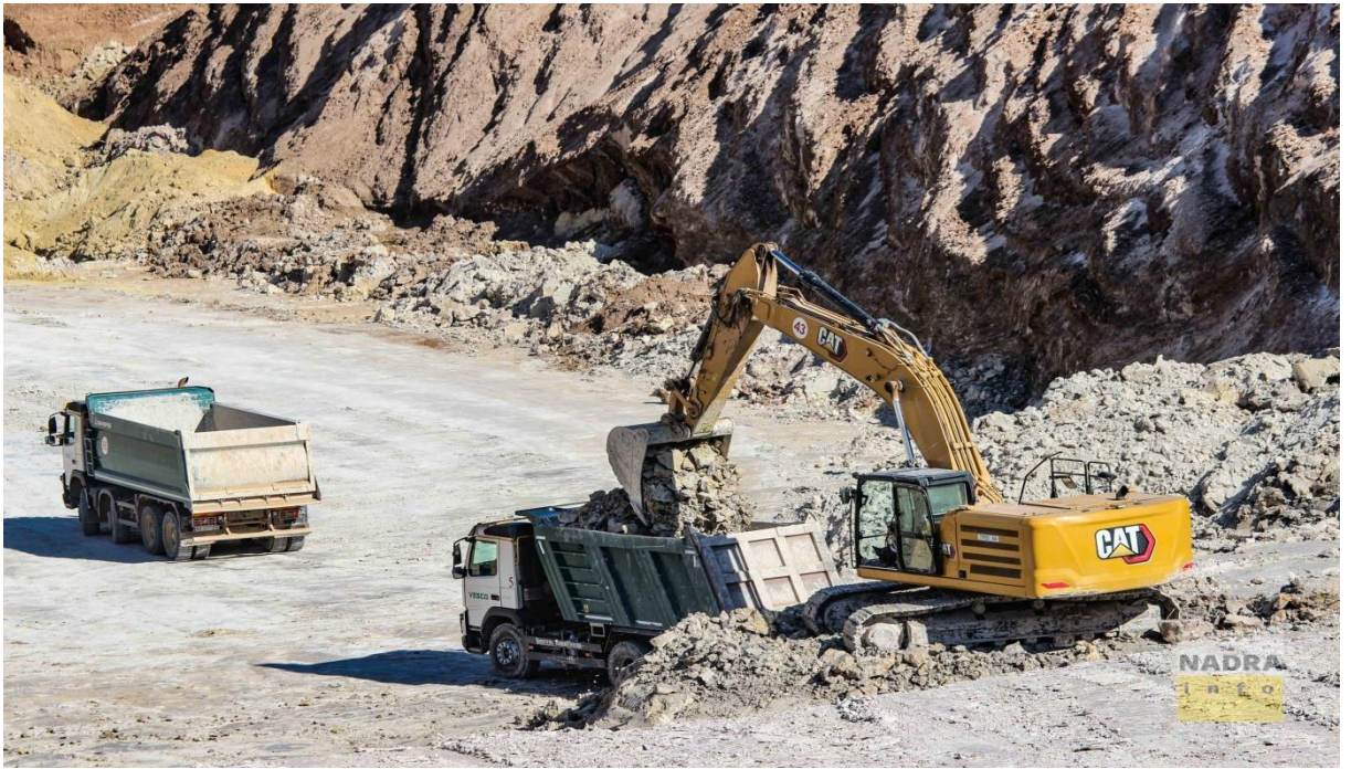
Рис. 2.3. Розробка видобувного уступу вогнетривких глин
