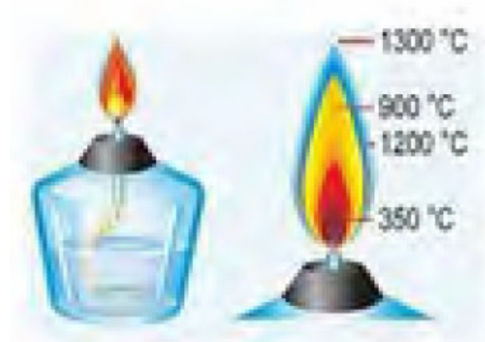
Рис. 6.1. Розподіл температури у полум'ї пальника (спиртівки)
