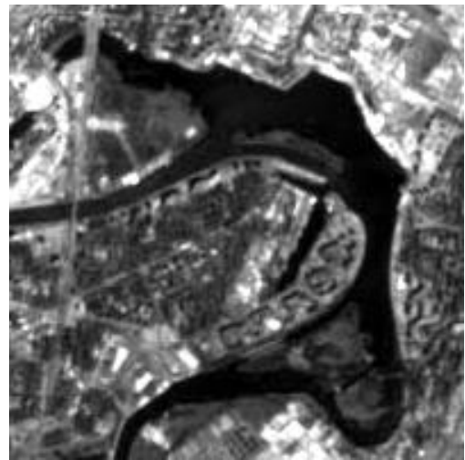
Рис. 3.5 Первинні зображення (КА Січ-2): а) панхромне та б) інфрачервоного; в) червоного; г) зеленого діапазонів проміння
