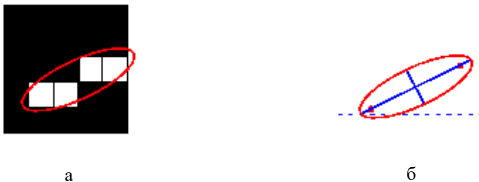
Рис. 1.2. Орієнтація об'єкту а) геометричний об'єкт та відповідний йому еліпс; б) еліпс з наведеними вісями (сині суцільні лінії) та фокусами (червоні точки), шуканий кут - кут між пунктирною лінією та головною віссю
