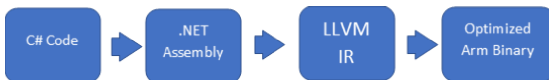
Рис. 3.3 Burst перетворює код HPC# в LLVM IR
