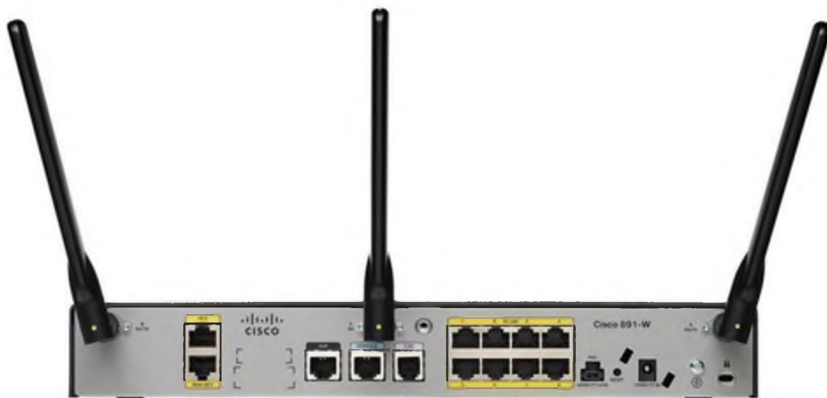
Рисунок 2.5 – Задня панель маршрутизатора Cisco 891W-AGN-A-K9
