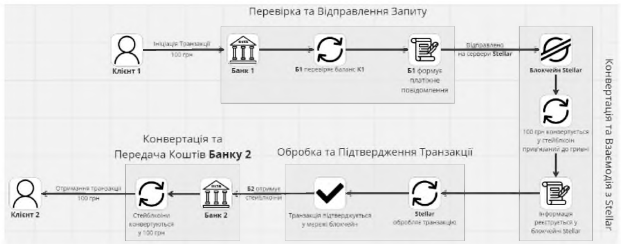
Рисунок 2.2. Розписана схема прикладу транзакції яка використовує систему блокчейн
